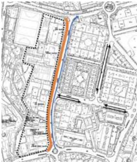
Ilustración 34. Conversión en sentido único y ampliación acera oeste en Avenida de Valencia.
