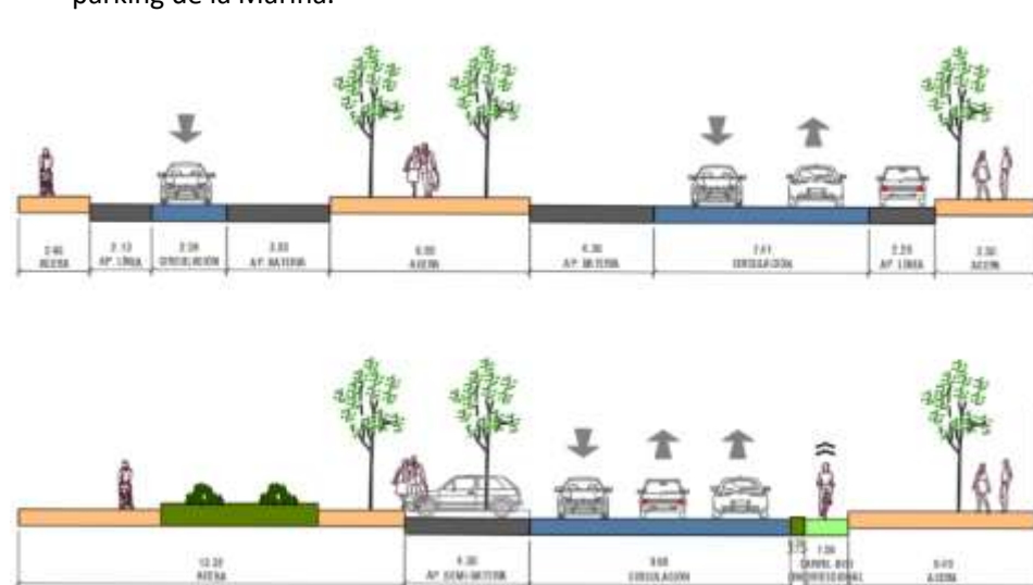
Ilustración 26. Sección actual y tipo propuesta para la Av. Reyes Católicos. Fuente: DOYMO
